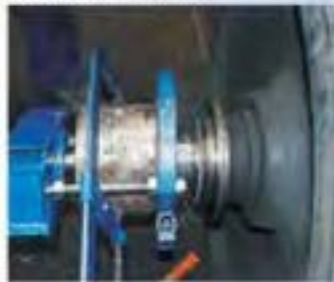
Stahování vnitřních kroužků vagonových ložisek a labyrintů
